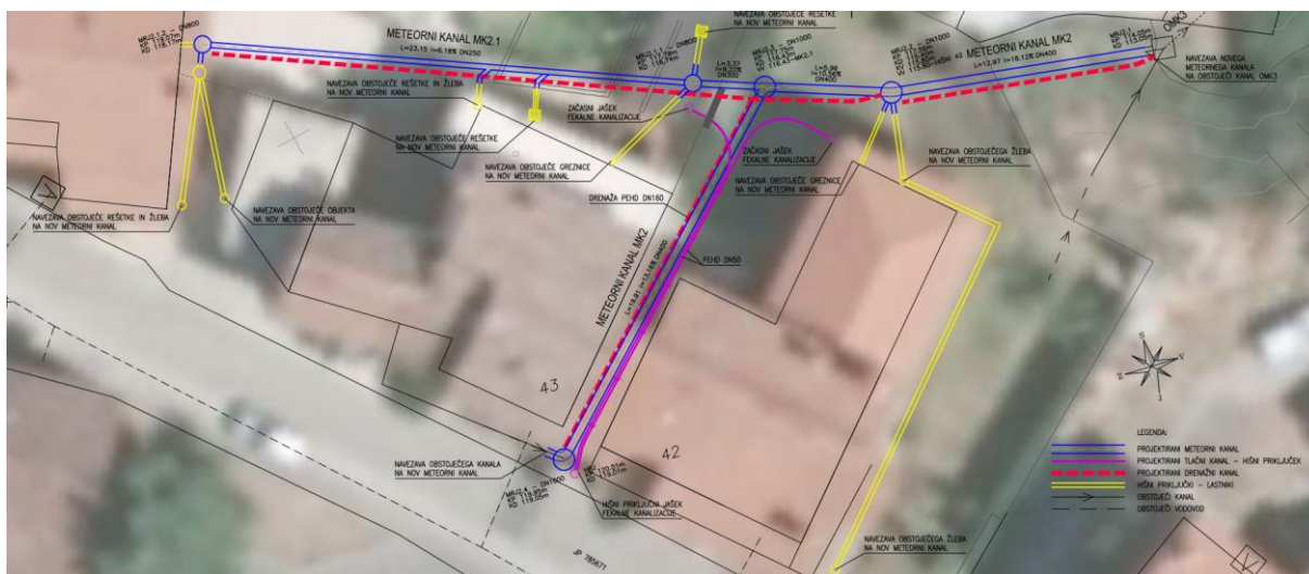
Slika 5: Izveden meteorni kanal MK2
